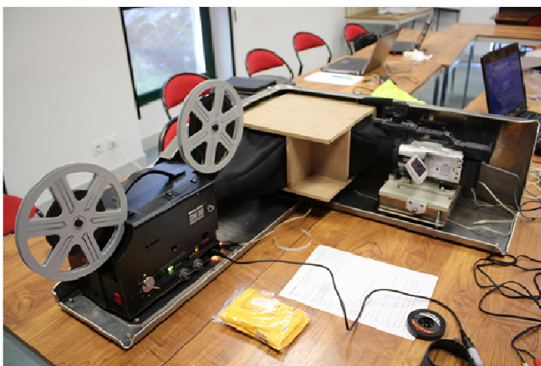
Banc de numérisation films super 8, en cours de réalisation.
